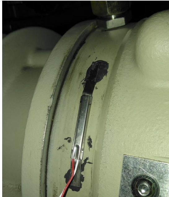
Toma de datos de temperatura de un motor mediante la Pt 100
